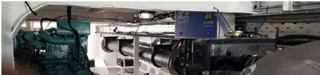
Figura 8. Ejemplo de aturdidor eléctrico en tubo instalado en un barco (Ace Aquatec, 2024).
