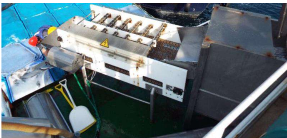
Figura 9. Aturridor de Optimar con la unidad de deshidratación (derecha) usada en las costas de Turquía para aturdir doradas y lubinas ( Optimar, 2024 ).
